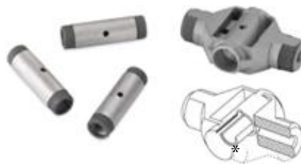
Figura 9. Tubos de grafite com aquecimento longitudinal e com aquecimento transversal (THGA).
